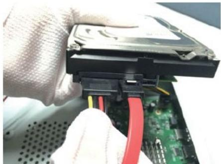
3. Schließen Sie ein Ende des Festplatten-Stromkabel an die Schnittstelle der NVR- Hauptplatine und das andere Ende an die Festplatte an.
